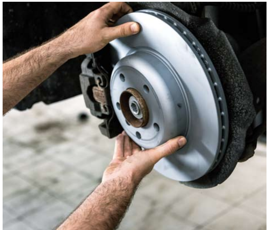
Drganie hamulca jest zazwyczaj odczuwalne jako wstrząs boczny na kierownicy, pulsacja na pedałach lub nawet wibracje w podłodze podczas hamowania
