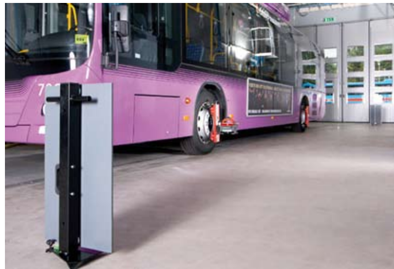
Rys. 14. Ustawienie elementów przyrządu i-track firmy Josam podczas pomiaru geometrii podwozia autobusu (źródło: Josam)
