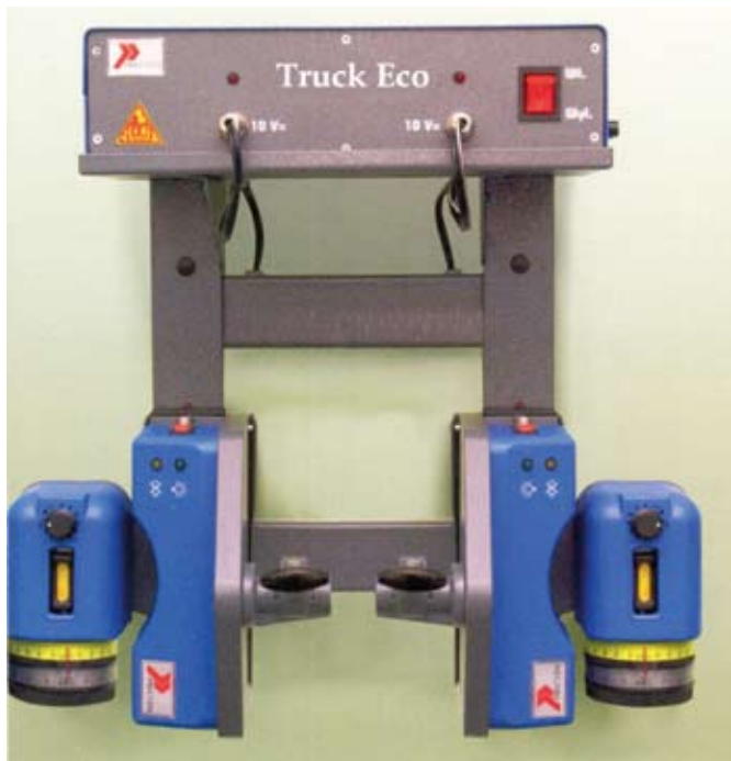
Rys. 4. Stanowisko odkładcze i zespoły pomiarowe urządzenia laserowego Truck Eco (źródło: Precyzja-Technik)
