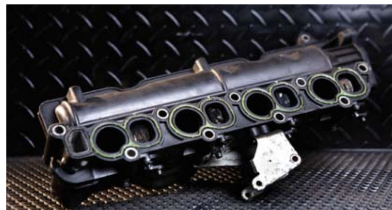
W dieslu najczęściej kłopotu sprawiają klapki. Te bez demontażu można oczyścić preparatem Liqui Moly nr 5168
