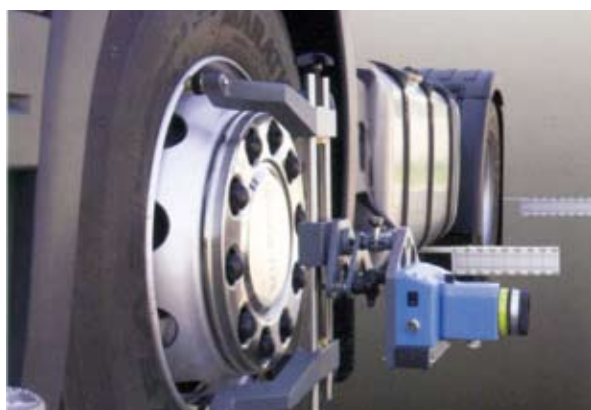
Rys. 6. Przykładowe rozmieszczenie zespołów przyrządu Truck Eco podczas wykonywania pomiarów (względem osi symetrii ramy) – źródło: Precyzja-Technik
