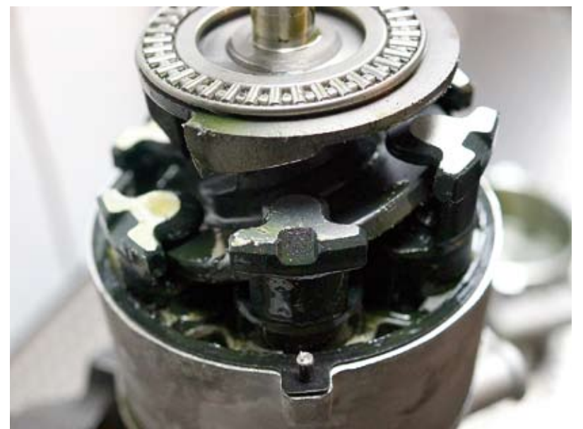
Olej zanieczyszczony środkiem uszczelniającym - widoczne zanieczyszczenia na płycie wychylnej i tłokach
