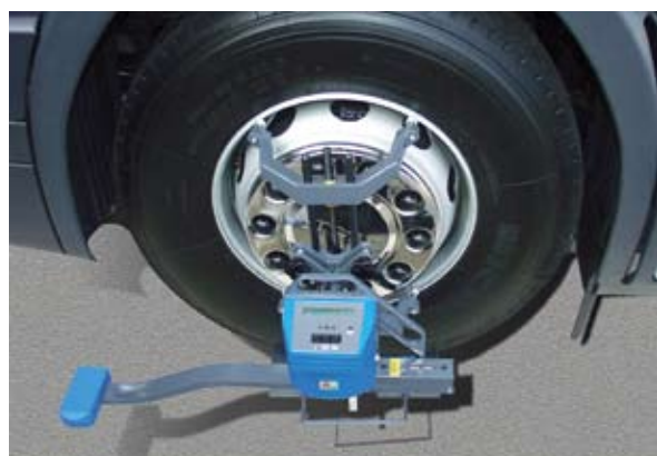
Rys. 8. Zacisk mocujący i zespół pomiarowy przyrządu GTL Truck (źródło: Precyzja-Technik)
