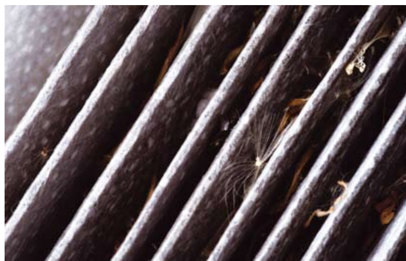
Pokaż klientowi jak wygląda zapchany filtr kabinowy
