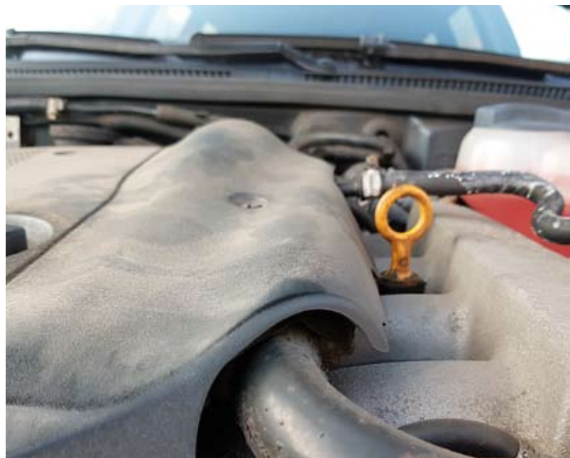
Zabrudzona, zaolejona komora silnikowa degraduje filtr kabinowy
