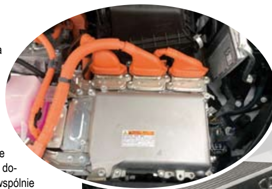
Komora silnika samochodu marki Lexus z widocznym modułem mocy i przewodami instalacji wysokowoltowej (kolor pomarańczowy) napędu hybrydowego
